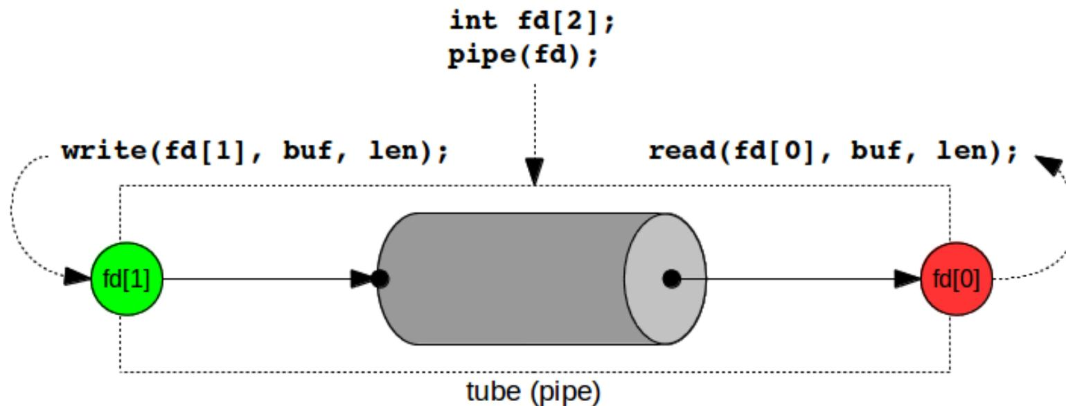
Un tube est créé par l'appel système `pipe(int descripteur[2])` qui remplit le tableau descripteur avec les descripteurs de chacune des extrémités du tube (l'entrée en lecture seule et la sortie en écriture seule).
