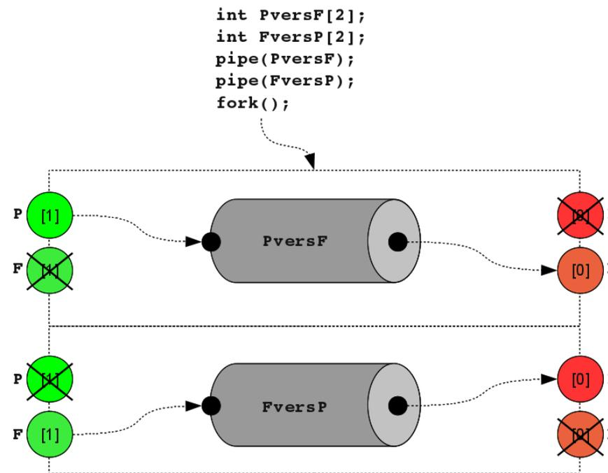
La création de ces deux tubes est sous la responsabilité du processus père. Ensuite, la primitive `fork()` réalisant une copie des données dans le processus fils, il suffit pour le père et le fils de fermer les extrémités de tubes qu'ils n'utilisent pas.
