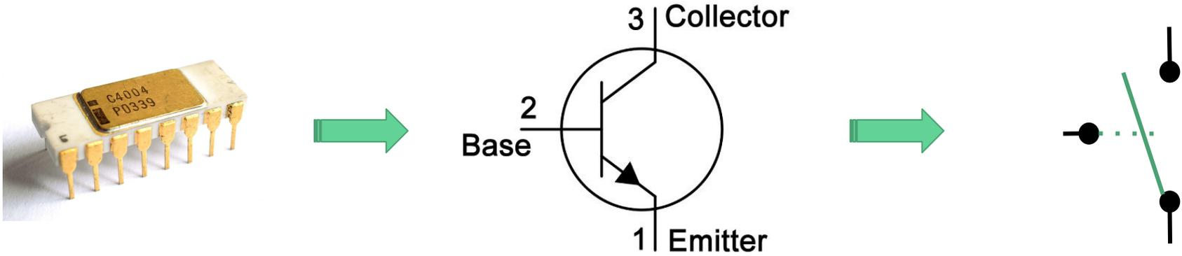
Le **4004** d'Intel est le premier microprocesseur commercialisé. Il intègre **2 300 transistors**. Avec une puissance d'exécution de **92 600 opérations par seconde** à une fréquence maximale de **740 kHz**, il est comparable à l'ENIAC, le premier ordinateur moderne dévoilé en 1946, qui occupait 167 m<sup>2</sup> pour un poids total de 30 tonnes.
