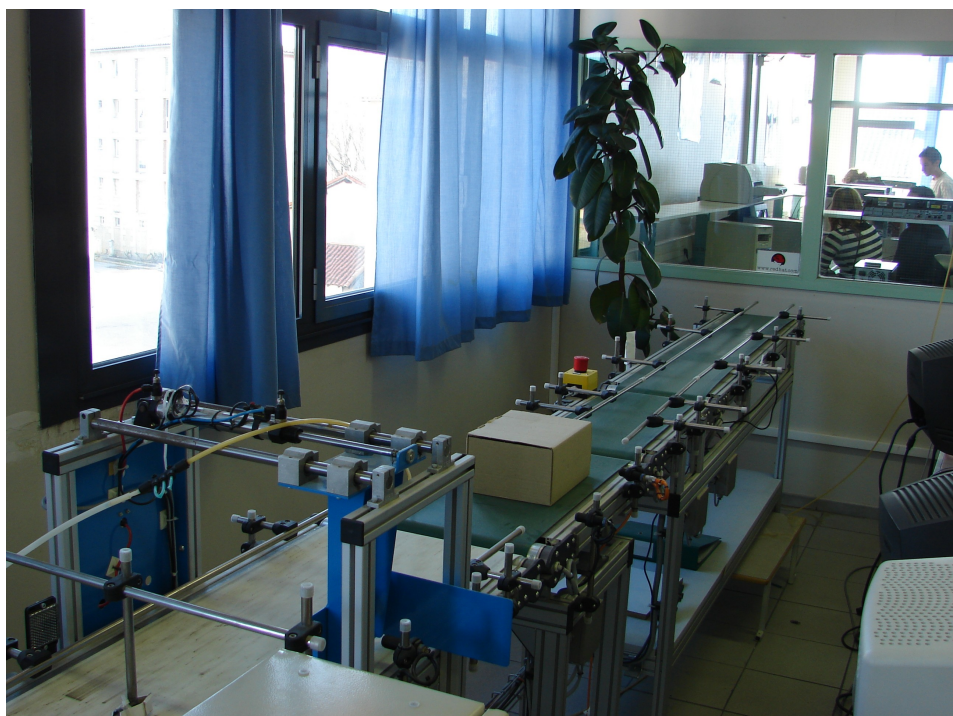
Système de production industrielle : contrôle pondéral et tri de colis
