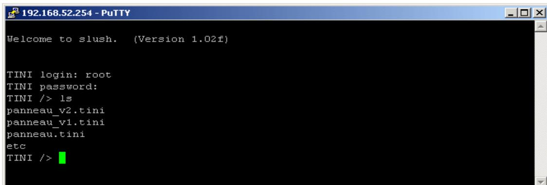
Dans la session Telnet ouverte sur la carte TINI, lancer l'exécution du programme `.tini` avec la commande `java` (machine virtuelle), par exemple :
