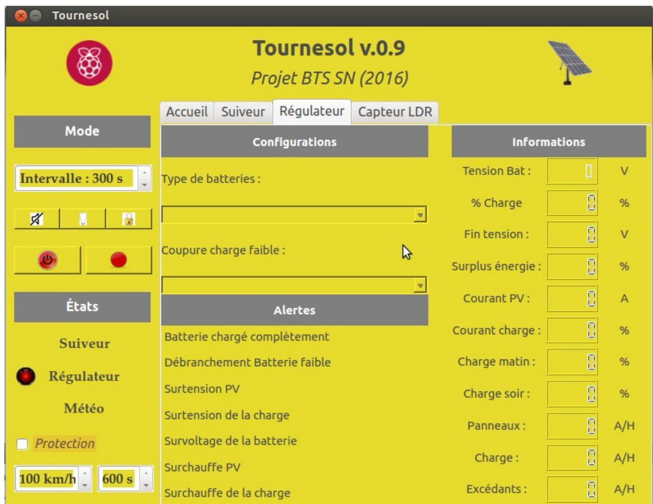
Dans l'onglet « Informations » on peut voir apparaître les données du régulateur de charge (La tension de la batterie, le niveau de charge, ...)
