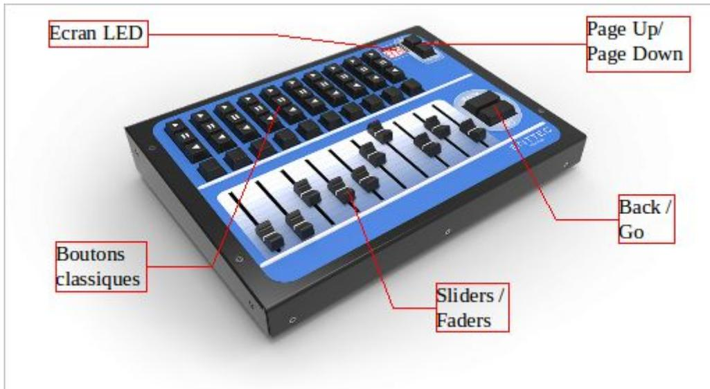
La console Playback Wing dispose de 10 faders (des boutons coulissants aussi appelés sliders), de 40 boutons classiques et 4 autres touches de contrôle, Page Up, Page Down, Back et Go. Durant ce projet, seul les touches de contrôles et les faders sont utilisés. Les faders contrôlent les projecteurs directement et les touches de contrôle possèdent chacune des fonctionnalités:
