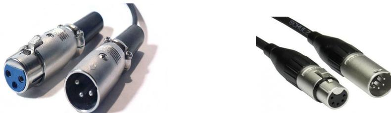
La broche n°1 fait office de masse/blindage pour limiter les pertes tandis que la broche n°2 représente le point Chaud qui envoie les trames de données et la broche n°3, quand à elle, est le point Froid qui transmet la trame avec une polarité inversée .
