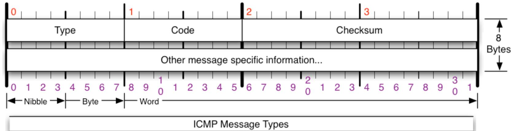
L'utilisation la plus connue du protocole ICMP est celle de la commande **ping** qui permet d'obtenir des informations (en particulier le temps de réponse de la machine à travers le réseau) et aussi quel est l'état de la communication avec cette machine.
